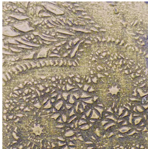
D.20 EFFETTO: OTTOCENTO MATERIALE: MARMORINO DI CALCE FINE COLORE: BRONZO FINITURA: CERA TRASPARENTE
