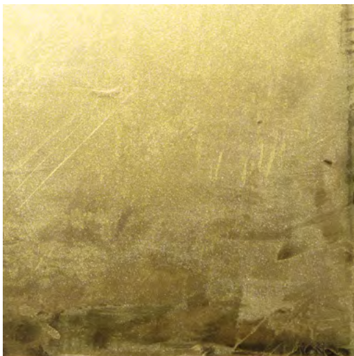
C.7 EFFET: GOLDEN DELABRÉ MATERIAUX : PLÂTRE À BASE DE CHAUX - 3 COULEURS ENDUIT COULEUR: MOKA, KING MIDAS GOLD FINITION: POLI
